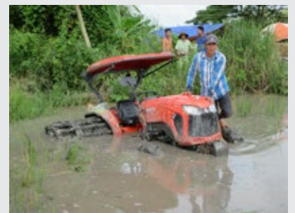
4 - Máy rơi vào vùng trũng sâu ► Bên dưới vỏ hộp số chạm đất cứng, 2 bánh trước bị nhấc lên cao, bánh lồng trượt trong bùn không có vị trí bám.
