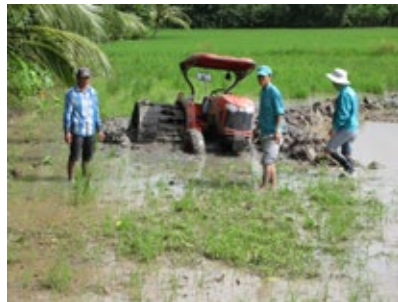
3 - Máy bị sa lầy khi rẽ cua đầu bờ (đất ướt và nhiều bùn)
