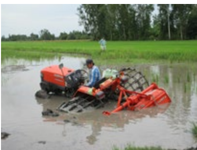
4 - Máy bị lầy khi một trong hai bên trái hoặc phải rơi vào vùng trũng sâu.
