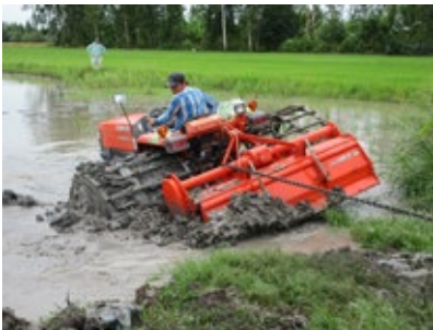
2 - Máy bị sa lầy đầu bờ khi mới xuống ruộng
